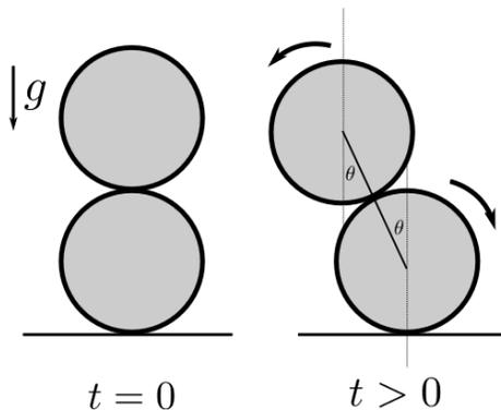
Figura 2: Dos cilindros en presencia de gravedad que ruedan sin deslizar
