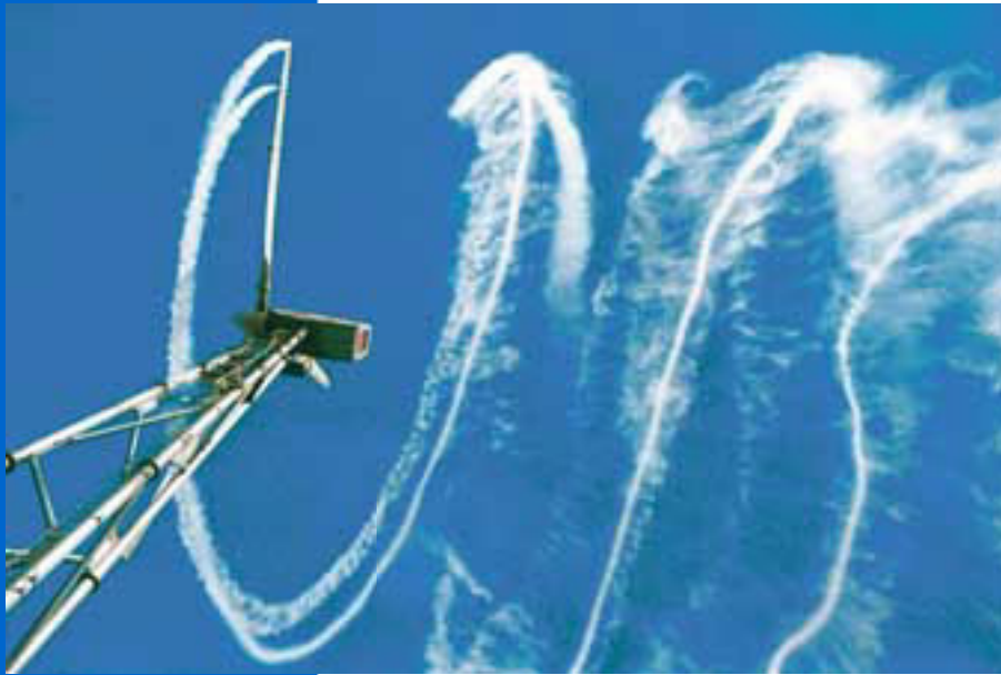
Efecto de la estela en un aerogenerador. Fotografía © 1997 Risø National Laboratory (Dinamarca)
