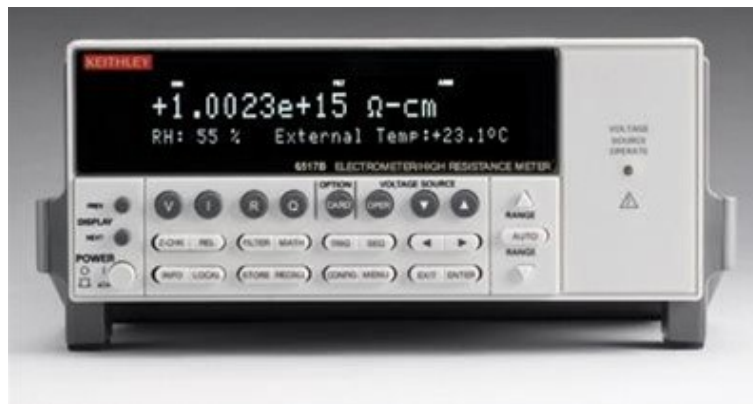
Figura 4.17: Modelo estándar de un electrómetro.
