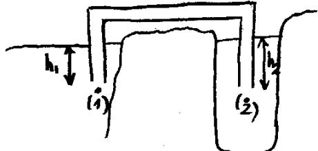
$$B_1 = z_e \quad (= (z_e - h_1) + \frac{(\gamma h_1)}{\gamma})$$
