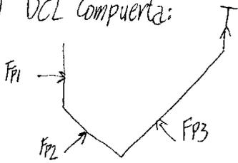
$$\sum \vec{T} = 0 \Rightarrow F_{p1} \cdot r_1 + F_{p2} \cdot r_2 = F_{p3} \cdot r_3 + T \cdot 2h \quad (1)$$
