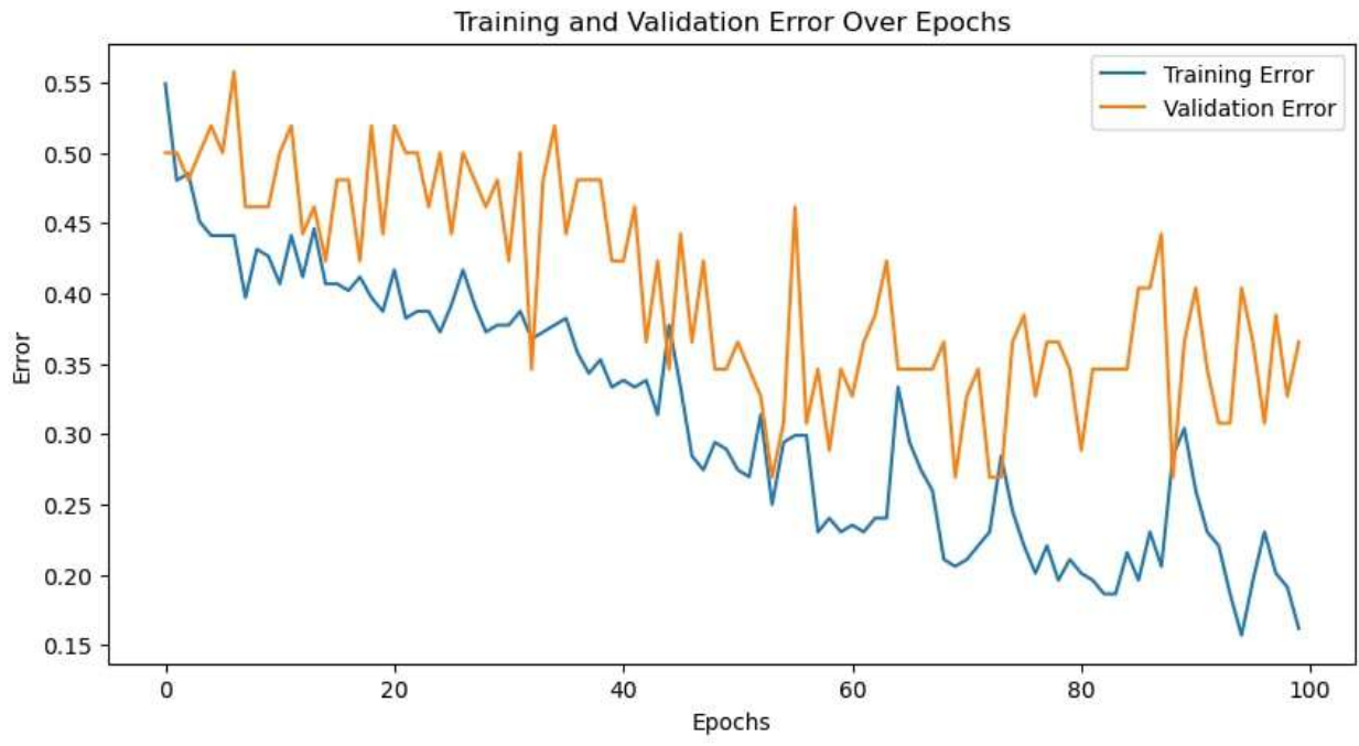
Figura C.72: Curvas de error en el conjunto de entrenamiento y validación, utilizando GRU y el caso flash filtrado.
