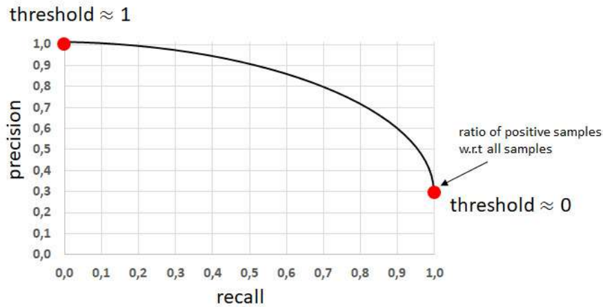
Figura 2.6: Comportamiento de una curva Precision-Recall [52].
