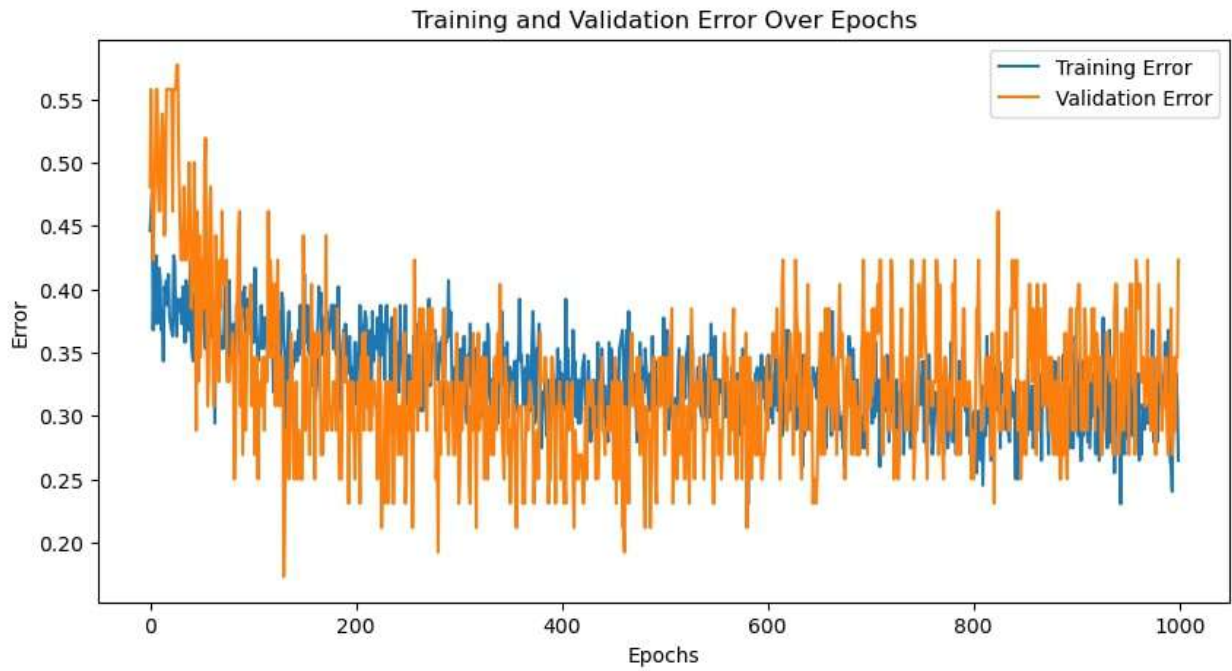
Figura C.36: Curvas de error en el conjunto de entrenamiento y validación, utilizando FCN y el caso flash filtrado.
