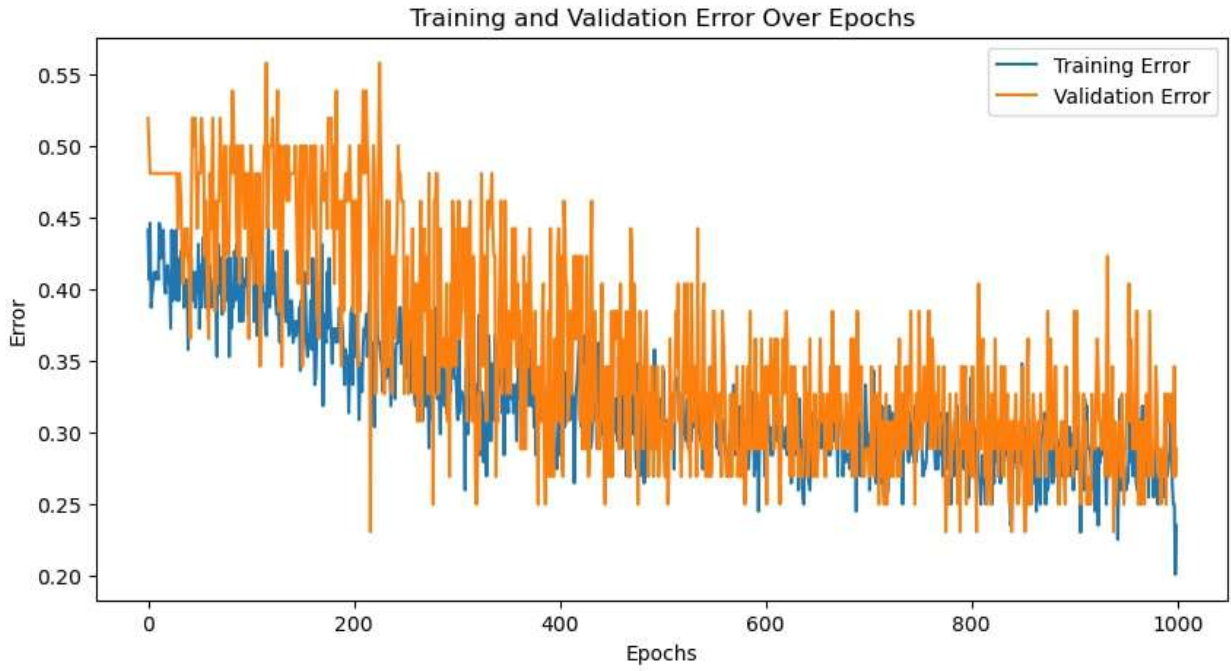
Figura C.30: Curvas de error en el conjunto de entrenamiento y validación, utilizando FCN y el caso rampa filtrado.
