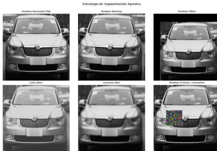
Figura 3.4: Ejemplos de la aplicación de data augmentation sobre una imagen del dataset (imagen frontal del vehículo Skoda, modelo Haorui del año 2012). Se observa la variedad de transformaciones geométricas y de apariencia implementadas para robustecer el entrenamiento.
