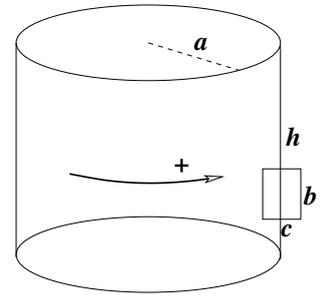
Figura 6.12: Manto cilíndrico conductor de altura  $h$  mucho mayor que su radio  $a$ .
