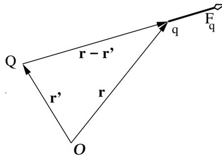
Figura 1.1: La fuerza  $\vec{F}_q$  sobre la carga puntual  $q$  ubicada en  $\vec{r}$  debido a la presencia de una carga puntual  $Q$  ubicada en  $\vec{r}'$  es colineal al vector de posición relativa  $\vec{r} - \vec{r}'$ .
