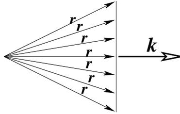
Figura 7.1: Los vectores  $\vec{r}$  que satisfacen  $\vec{k} \cdot \vec{r} = \Omega + \omega t$  definen un plano perpendicular a  $\vec{k}$ . Si se incrementa  $t$  se obtiene un nuevo plano paralelo al anterior. Más precisamente, si  $t \rightarrow t + \delta t$  se debe cambiar  $\vec{r} \rightarrow \vec{r} + \delta \vec{r}$  de tal modo que  $\vec{k} \cdot \delta \vec{r} = \omega \delta t$ .
