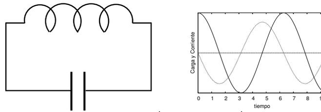
Figura 6.10: Izquierda: Un circuito ideal LC: la diferencia de potencial en el condensador debe ser igual a la fem autoinducida en la bobina. Derecha: la carga  $Q(t)$  (medida en Coulomb) representada por la línea continua y la corriente  $I(t)$  (medida en Ampère) en línea de puntos.
