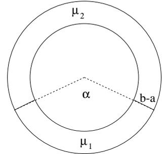
Figura 5.6: Un núcleo toroidal hecho con dos materiales diferentes.
