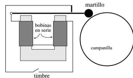
Figura 5.9: Diagrama del timbre común. Cuando circula corriente por las bobinas el martillo es atraído, golpea la campanilla y además abre el circuito.
