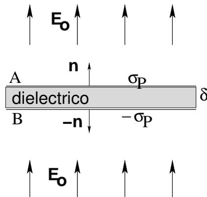
Figura 1.8: Una capa plana aislante de ancho delta está sumergida en un campo eléctrico perpendicular al plano y que en vacío es  $\vec{E}_0$ .
