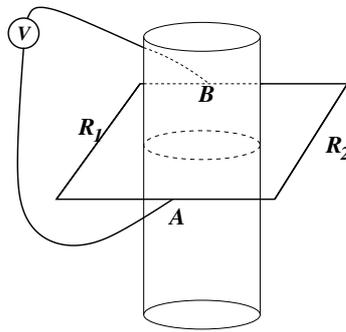
Figura 6.8: Existe un campo magnético variable solo dentro de un cilindro recto infinito. Alrededor de él hay un circuito rectangular con resistencias  $R_1$  y  $R_2$  en aristas opuestas. Se comprueba que un voltímetro mide una diferencia de potencial  $V$ , entre los extremos de las resistencias, que depende del lado en que está el voltímetro.
