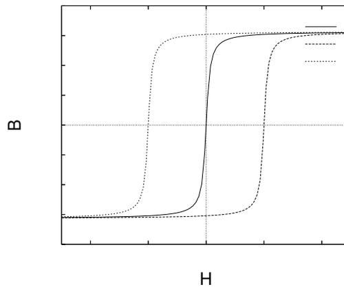
Figura 5.4: Histéresis de un material ferromagnético.
