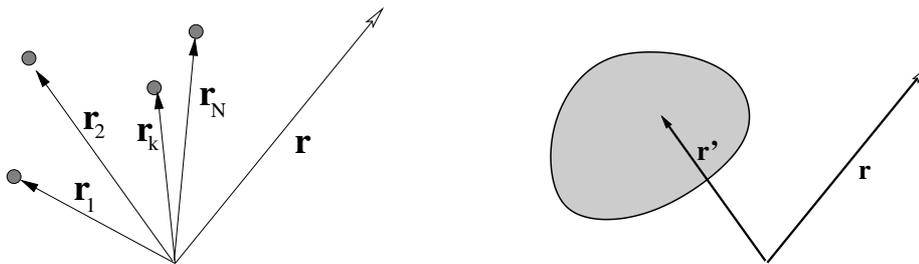
Figura 1.2: A la izquierda el campo eléctrico en un punto  $\vec{r}$  debido a un conjunto de cargas puntuales se obtiene como la simple suma vectorial de los campos que implica cada una. A la derecha se debe calcular el campo  $\vec{E}$  en  $\vec{r}$  debido a una distribución continua de carga (recorrida por  $\vec{r}'$ ), el que se calcula usando (1.2.2).
