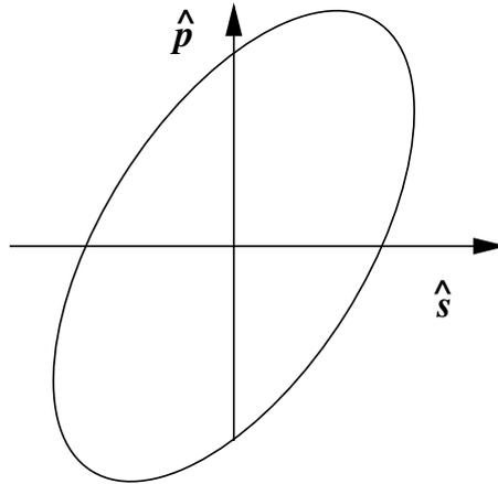
Figura 7.4: El vector campo eléctrico describe, en el caso general, una elipse en el plano  $(\hat{s}, \hat{p})$  ortogonal al vector de onda  $\vec{k}$ .
