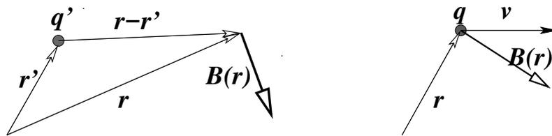
Figura 4.1: A la izquierda una carga  $q'$  en movimiento produce un campo magnético  $\vec{B}(\vec{r})$  definido en (4.1.3) en todo punto  $\vec{r}$ . A la derecha se tiene la acción de una fuerza magnética definida en (4.1.4) sobre una carga en movimiento en presencia de un campo magnético.
