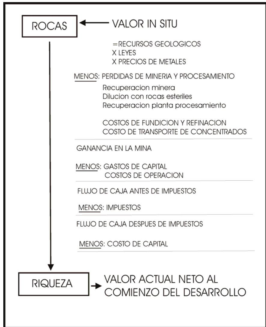
Fig. 5 PROCESO DE CONVERSION DE ROCAS EN RIQUEZA
