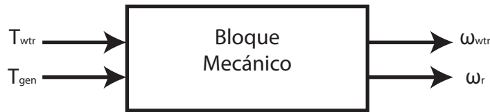
Figura 2.2.2: Bloque mecánico del aerogenerador.
