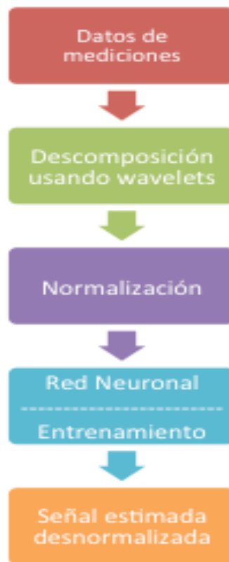
Figura 38 Predicción de la demanda eléctrica usando Wavelet y PSO en el entrenamiento de la red neuronal WNNs-PSO
