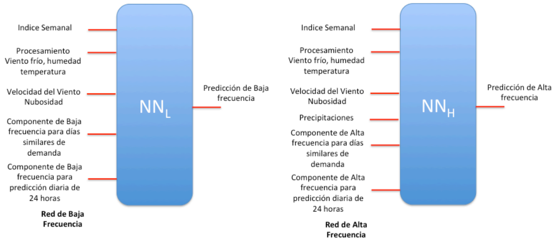
Figura 37 Entradas de las redes neuronales del modelo de predicción de corto plazo en base de días similares, wavelet y redes neuronales (SIWNN - Similar Day-Based Wavelet Neuronal Network) [82]
