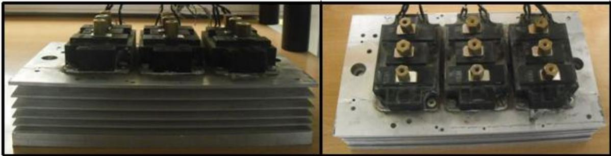
Figura 67. Montaje de IGBTs en disipador
