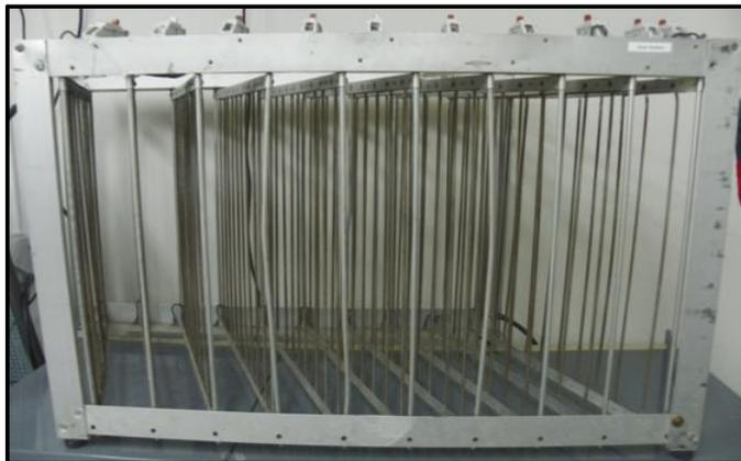
Figura 143. Imagen real del banco resistivo presente en el prototipo
