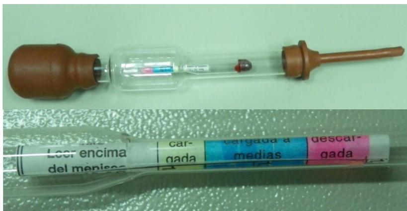
Figura 14. En imagen superior se observa la forma física de un acidómetro, en la imagen inferior se muestra el flotador del acidómetro
