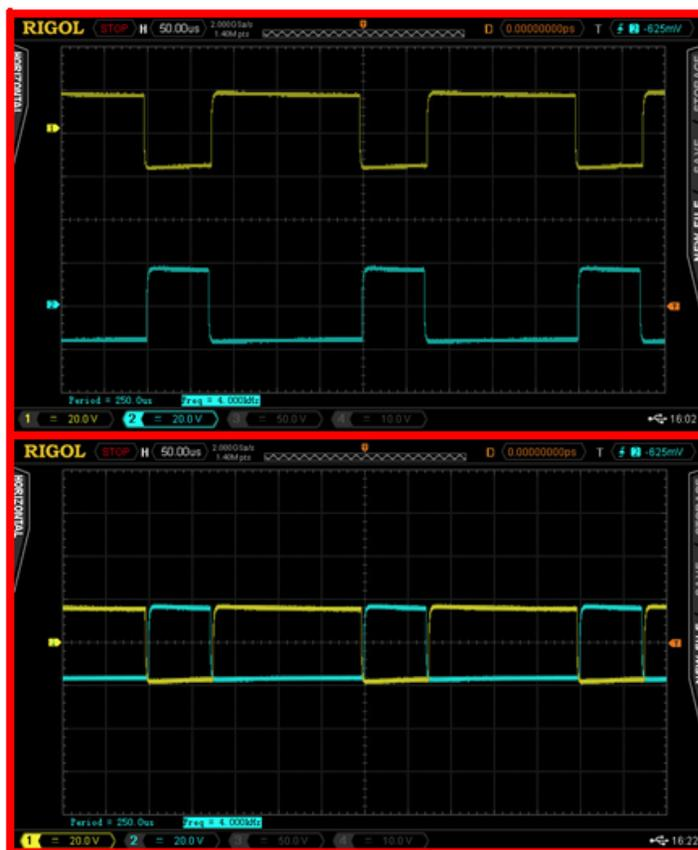
Figura 77. En la imagen superior se ve los pulsos de disparos de la fase 1, mientras que en la imagen inferior se presenta una superposición de éstas
