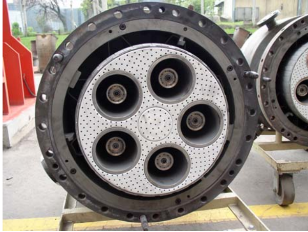
Figura 8: Vista frontal de los inyectores de las cámaras de combustión de la turbina a gas de la Central Nueva Renca
