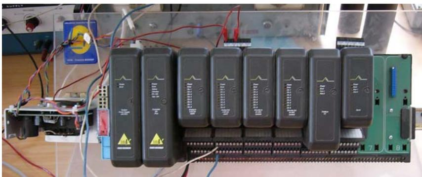
Figura 4.2.1: Controlador DeltaV y módulos I/O
