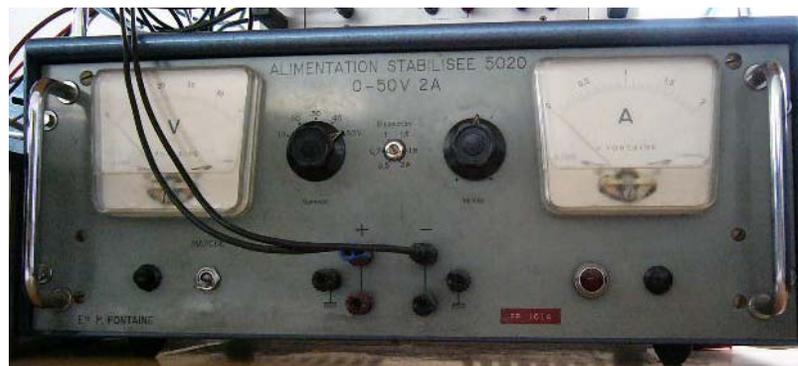
Figura 5.2.7: Fuente Voltaje Continuo 50V
