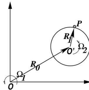
referencia  $S'$  centrado en  $O'$  y que mantiene sus ejes paralelos a los del sistema inercial  $S$ ; (b) idem para el sistema  $S''$ , también centrado en  $O'$  pero con sus ejes girando de tal modo que  $P$  siempre está sobre el eje  $X''$ .
