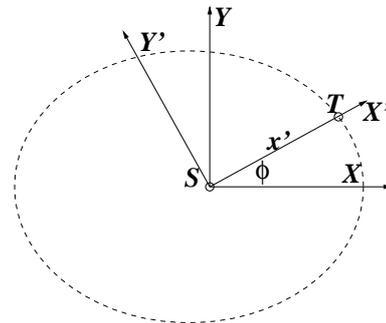
Figura 7.5: Se puede describir el movimiento de un planeta desde dos sistemas de referencias centrados en el Sol. Uno de ellos es inercial y el otro gira de modo que el planeta está siempre sobre el eje  $X'$ .
